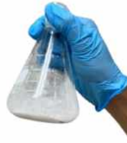
◀ Figure 10 - Séchage : \text{MgSO}_4 pulvérulent
