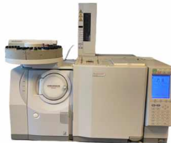
Chromatographe ► utilisé, fonctionnant avec un spectromètre de masse
