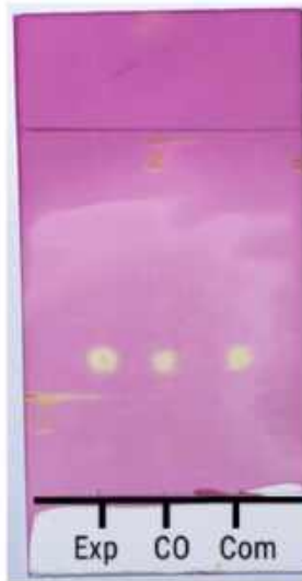
Figure 14 - Révélation par KMnO 4 (oxydant)
