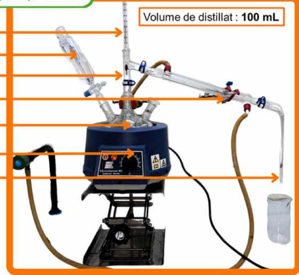
▲ Figure 7 - Dispositif expérimental d'hydrodistillation
