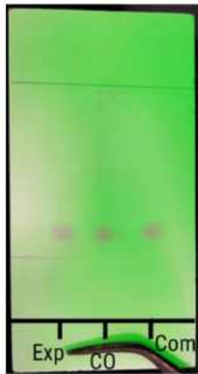
Figure 13 - Révélation sous lampe UV (260 nm)
